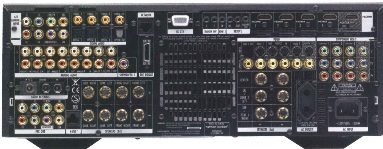
■ **DOMOTICA? SÌ, GRAZIE** La vocazione domotica dell'Harman/Kardon è testimoniata dalla presenza di un connettore A-BUS. Basta un cavo CAT-5 per portare segnale audio, alimentazione, dati e segnali di stato agli hub, che provvedono a smistarlo ad altri dispositivi A/V.
