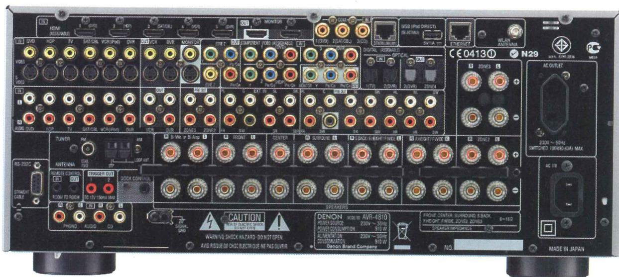
■ **ANCHE PHONO** C'era da aspettarselo, ma fa sempre piacere trovare in un sintoamplo A/V anche un'entrata phono. Quella dell'AVR-4810 accetta testine MM; per le MC bisogna ricorrere a un pre phono separato. La messa a terra è, insieme al connettore SMA per il Wi-Fi, l'unico connettore non placcato oro.
